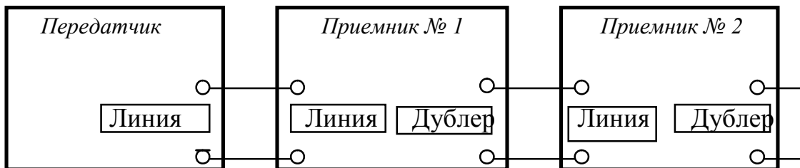
Рис.3 Схема соединения передатчика с приемниками при двухпостовой работе.
